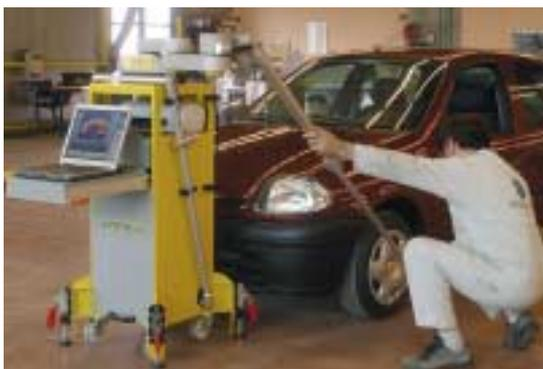
Así mismo, se debe seleccionar la longitud del puntero en uso (de 100, 200 o 350 mm), la posición del mismo (0° frontal, 45° oblicua, o 90° perpendicular) y si se usa algún tipo de prolongador.
