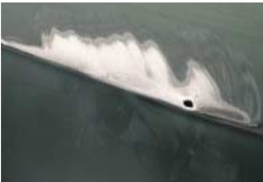
ORIFICIO PROVOCADO EN LA CHAPA POR ESTIRAR ERRÓNEAMENTE CON EL MARTILLO DE INERCIA
