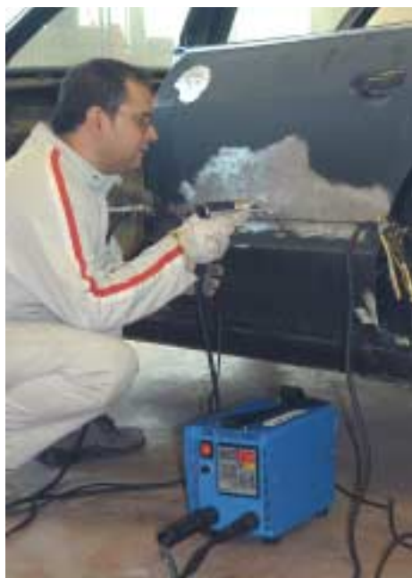
SOLDADURA DE PERNOS MEDIANTE EQUIPOS DE DESCARGA DE CONDENSADORES
