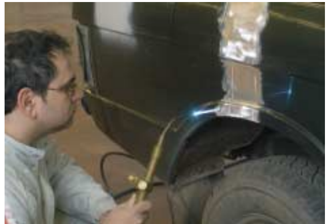
ATEMPERAMIENTO PREVIO DE LA ZONA A DESABOLLAR
