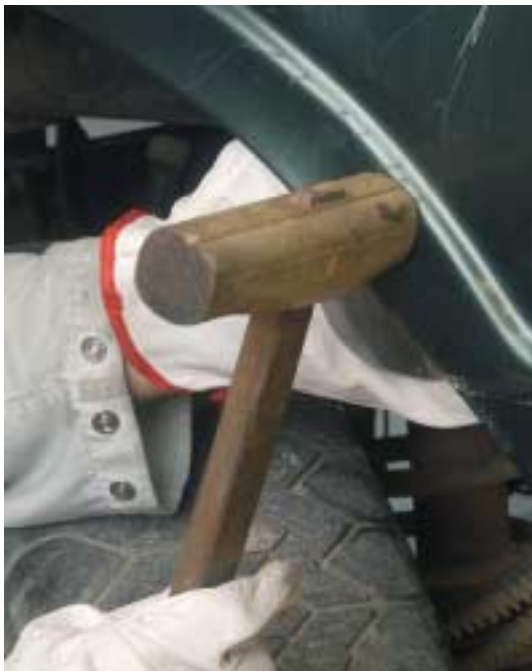
BATIDO DE PANELES EN PIEZAS DE ALUMINIO UTILIZANDO LA MAZA DE MADERA
