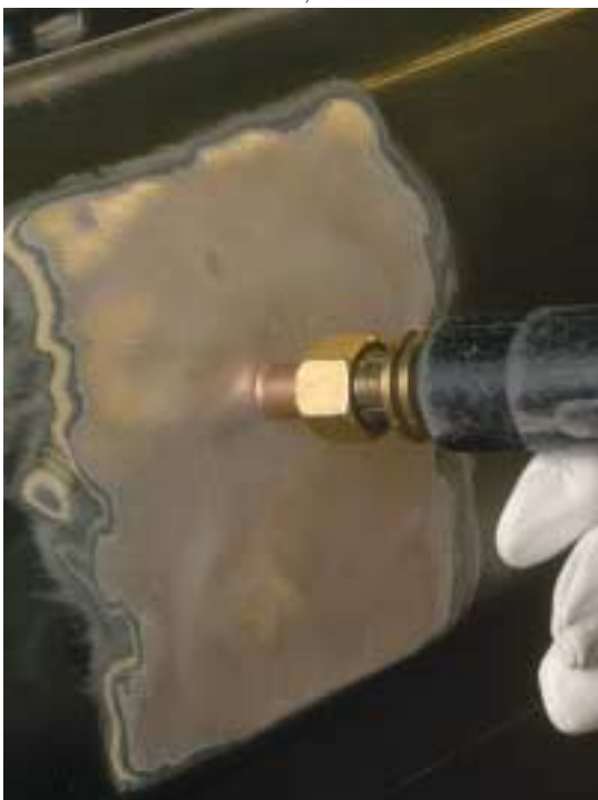
CONTRACCIÓN DE UN ESTIRAMIENTO DE CHAPA, DE BAJA INTENSIDAD, CON EL ELECTRODO DE COBRE
