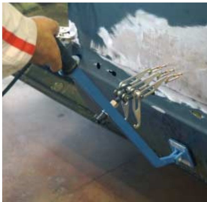
DESABOLLADO MEDIANTE SISTEMA DE TRACCIÓN
