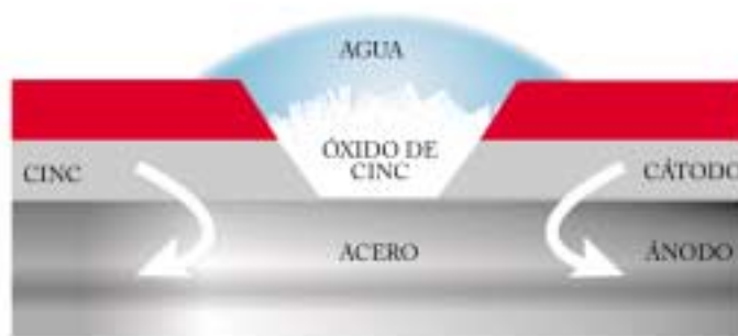
LA PRESENCIA DEL ZINC PROTEGE DE LA CORROSIÓN AL ACERO
