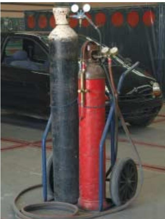
La utilización de esta soldadura provoca calor y chispas en las piezas, con su consiguiente riesgo de quemaduras y proyecciones de partículas.
