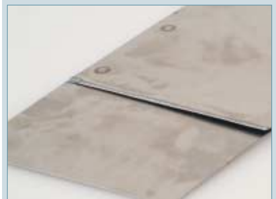
RESULTADO DEL CORTE, EN EL QUE OBSERVA QUE, BIEN REGULADO EL EQUIPO, LA CHAPA INFERIOR NO RESULTA DAÑADA
