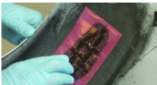
APLICACIÓN DEL ADHESIVO CON EL FILM PLÁSTICO CON REFUERZO EN EL INTERIOR
