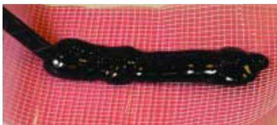
APLICACIÓN DEL ADHESIVO SOBRE EL FILM PLÁSTICO CON REFUERZO
