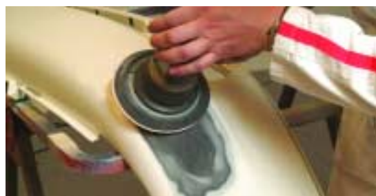
LIJADO DEL ADHESIVO
