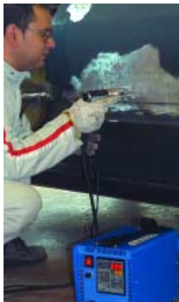
APLICACIÓN DEL EQUIPO PARA LA SOLDADURA DE ESPÁRRAGOS Y EL POSTERIOR ESTIRAJE EN CHAPA DE ALUMINIO
