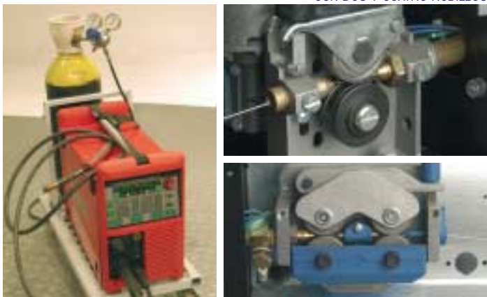
SISTEMAS DE ALIMENTACIÓN DE ALAMBRE CON DOS Y CUATRO RODILLOS
