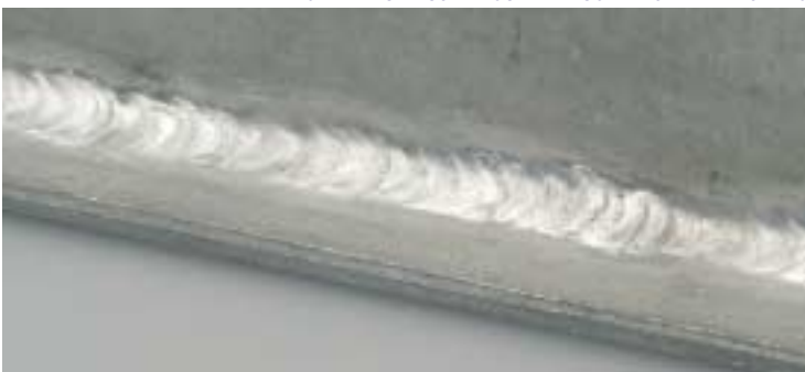
LA TECNOLOGÍA DIGITAL JUNTO AL ARCO PULSADO, PERMITE OBTENER EXCELENTES RESULTADOS EN LA SOLDADURA DE ALUMINIO
