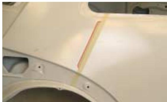
**8** CASO B: Para la unión con solape, se coloca una cinta de la anchura del solapado a realizar, de forma que el trazado de la línea de corte se extienda al ancho del solape.
