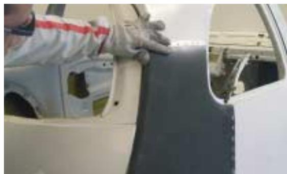
**10** Presentar de nuevo el recambio sobre la zona preparada y fijarlo para comprobar su correcta posición, montando las piezas colindantes. De esta forma, que preparada la pieza para el proceso de unión.
