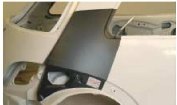
**4** Presentar el recambio en la carrocería y fijarlo (dependiendo de cual sea la pieza dañada, puede ser necesario el desmontaje previo de esta pieza).
