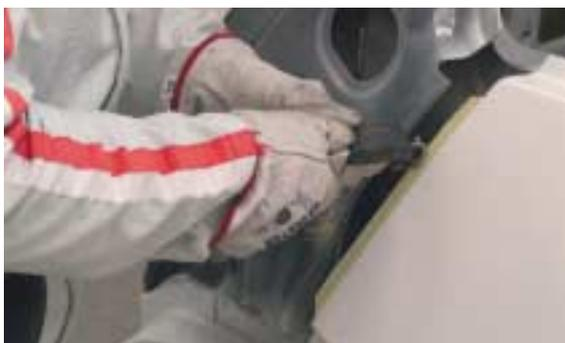
**9** Cortar la pieza dañada en la carrocería por la línea trazada, y retirar los restos.
