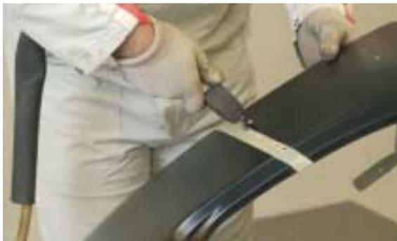
**3** Cortar el recambio por la línea de corte con sierra alternativa.
