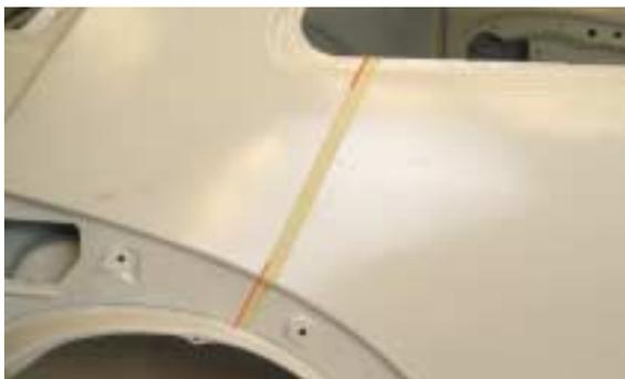
**7** CASO A: Cuando el recambio se vaya a soldar a la carrocería por unión sin solape, el corte se realiza por la línea trazada.
