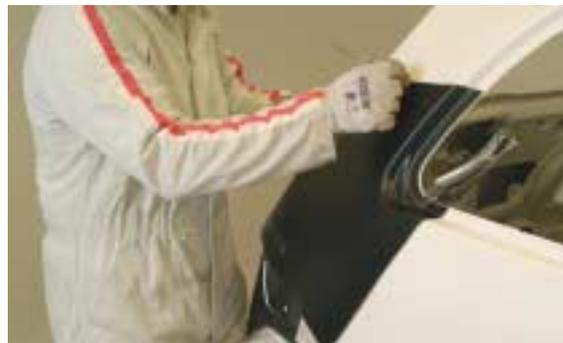
**6** Marcar la línea de corte en la carrocería, utilizando como plantilla el recambio nuevo.
