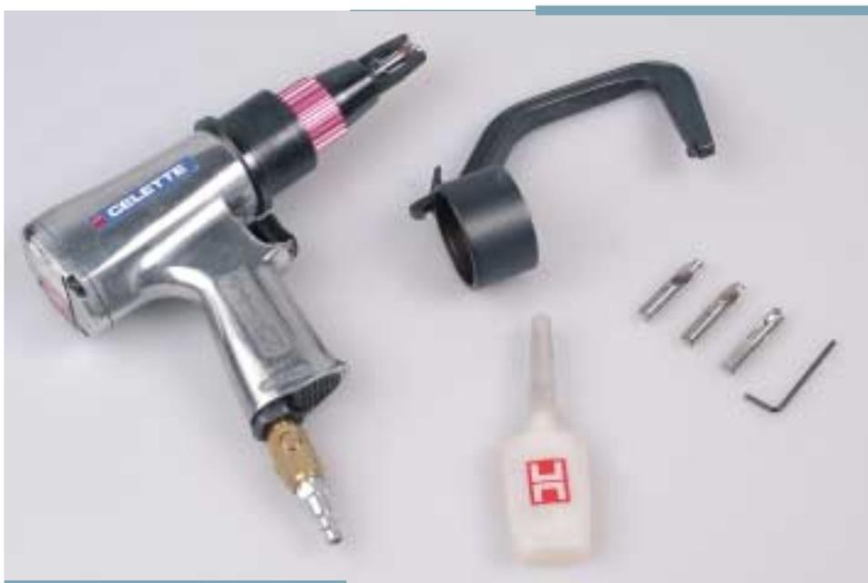
Esta nueva despunteadora destaca por su sencillez de manejo a la hora de la eliminación de los puntos de soldadura, por medio del fresado, en los procesos de sustitución de piezas de la carrocería, destacando el poco esfuerzo que el chapista debe hacer para su manejo, gracias a su sistema neumático de empuje de la fresa.
