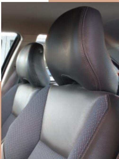
**D**urante una colisión por alcance a poca velocidad, el respaldo y el reposacabezas son los elementos primarios de conexión entre el vehículo y el ocupante, y si bien en las colisiones frontales y laterales el asiento sólo contribuye en parte a la retención del ocupante, en las colisiones por alcance representa, junto con el reposacabezas, todo el sistema de retención de que dispone el ocupante.
