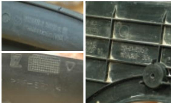
**1** En primer lugar se debe comprobar si existe la marca del plástico de fabricación de la pieza.
