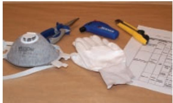
**2** Si no existe la marca se pasa a realizar el ensayo de pirólisis. Se prepara el equipo: encendedor, cutter y tabla de características de combustión.
