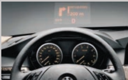
IMAGEN DE UN PARABRISAS EQUIPADO CON EL SISTEMA "HEAD UP DISPLAY"
