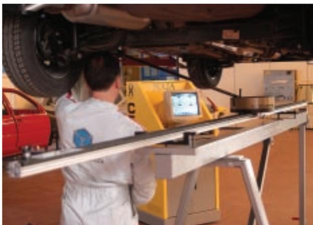
*PROLONGADORES Y ADAPTADORES DEL EQUIPO PARA EL CORRECTO AJUSTE DE LOS PUNTOS DE CONTROL.*
