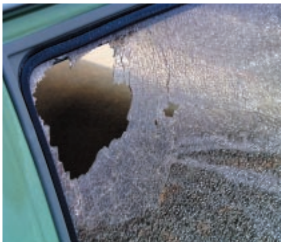
Cuando una luna templada se rompe, se destruye totalmente en numerosos fragmentos.
