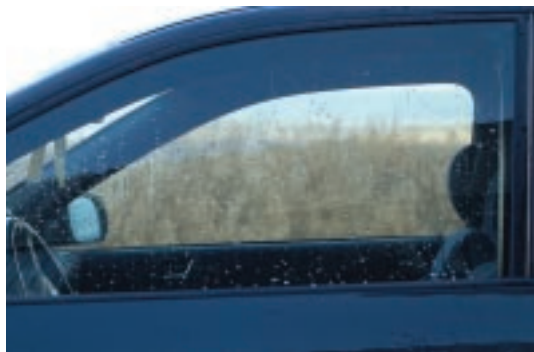
El vidrio fabricado con una capa hidrofóbica ayuda a la evacuación del agua.
