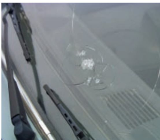
En una luna laminada rota, los fragmentos de vidrio quedan adheridos a la lámina de PVB.
