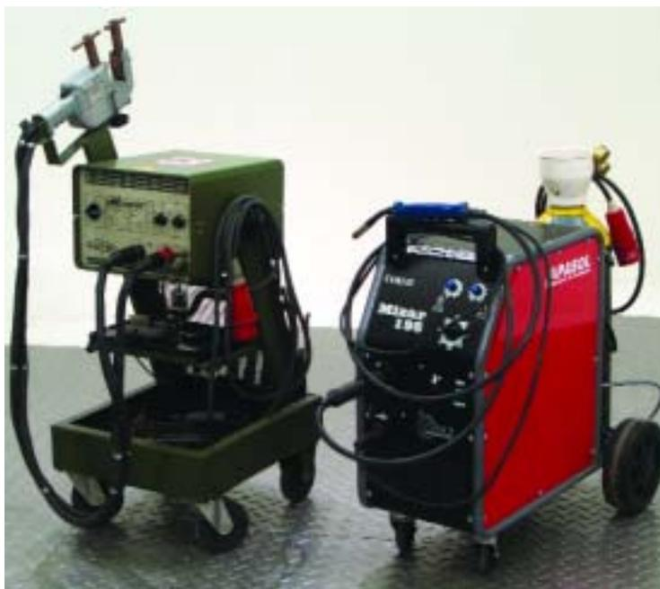
*Equipos de soldadura MIG / MAG y de resistencia eléctrica*
