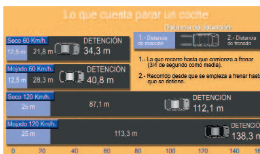
Gráfico 2 Distancias de detención en función de la velocidad y del estado del pavimento (Seco o mojado).
