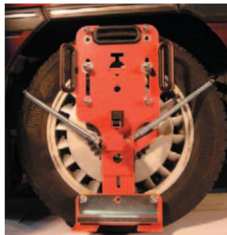
Soporte instalado en la rueda. Muelle de seguridad.
