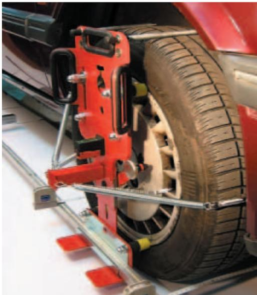
Soporte alineador con regla "lanzadera" y flexómetros midiendo de lado a lado
