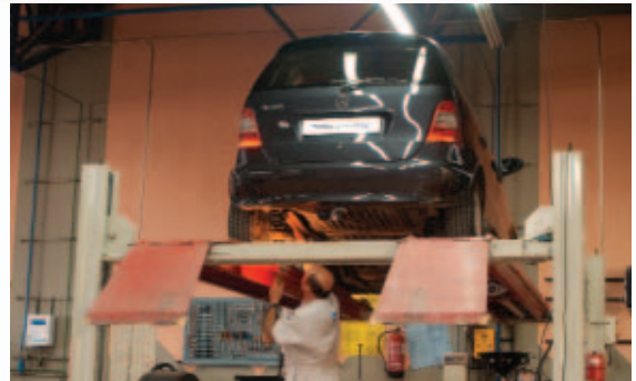
2 Inspeccion visual de los elementos de la suspensión del automóvil a verificar: Comprobar que no existen roturas o deformaciones en amortiguadores.
