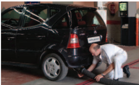
3 Posicionar el automóvil en el puesto de medición con el motor funcionando. Verificar la correcta posición de inflado de las ruedas. Conectar al escape el boquerel de aspiración de humos.
