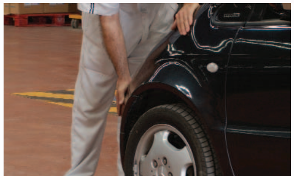
4 La prueba de medición de la suspensión recomendada debe realizarse en caliente, es decir, después de haber recorrido un trayecto de varios kilómetros.
