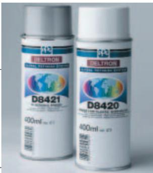
D8420 es una nueva imprimación para plásticos, que supone una variante de la actual D820. Este aerosol es una imprimación de adherencia transparente y lista al uso, que está teñida de color rosa para ayudar al usuario en la aplicación. Puede utilizarse sobre una amplia variedad de sustratos plásticos, excepto PE, PC, ABS, PU/PUR, PP y POM.
