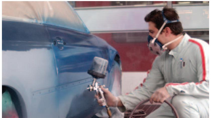
La "extrarrápida", como la llama SATA, es una pistola híbrida que emplea una presión reducida (RP) con la que se logra alcanzar una eficacia de transferencia superior al 65%, y con la que se obtiene una alta rapidez de trabajo.
