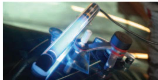
*Secado con la lámpara de rayos ultravioleta.*
