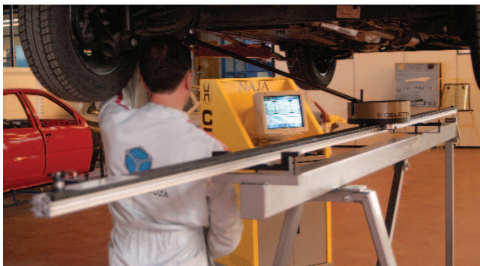
Sistema de medición electrónico Naja de Celette, montado sobre el soporte gazelle que permite medir con el vehículo en el elevador
