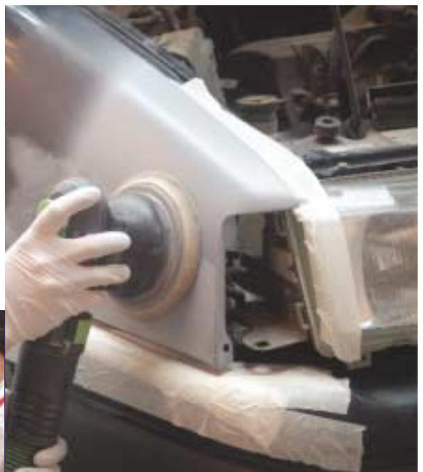
Las pinturas de preparación o fondo tienen como misión la preparación de las piezas para la aplicación de las pinturas de acabado. Por tanto, al estar en contacto directo con el material del soporte, deberán protegerlo frente a los agentes externos y conseguir una buena base que sirva de anclaje para la pintura de acabado.
