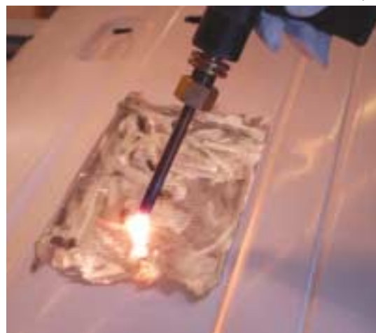
Calentamiento de la chapa
