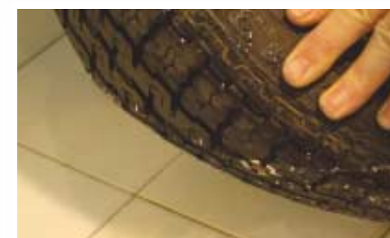
10 Inflado del neumático hasta la presión correcta, comprobación de la reparación (fugas) y montaje de la rueda.
