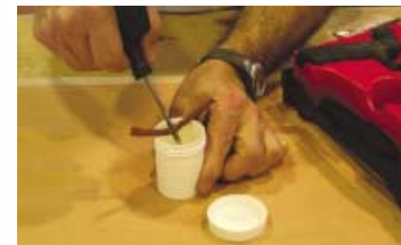
6 Lubricar la punta del útil de inserción.
