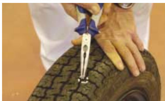
3 Extracción del objeto causante del pinchazo siguiendo su ángulo de introducción
