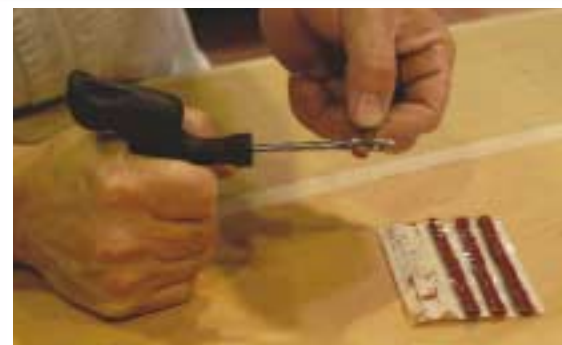
5 Introducir el material de reparación dentro del útil de inserción.
