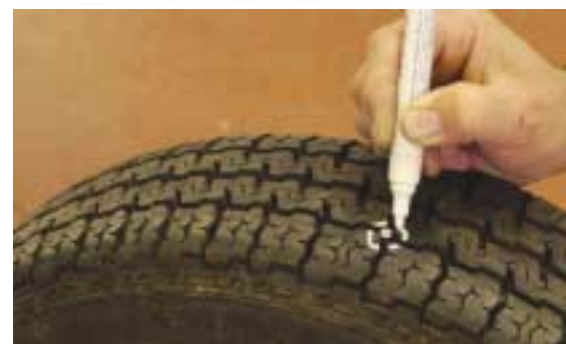
2 Desmontaje de la rueda con el neumático averiado, localización (observar el ángulo de introducción del objeto causante del pinchazo) y marcado del pinchazo.
