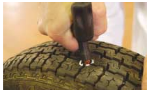
7 Introducir (presionando) mediante el útil de inserción, el material de reparación en el orificio del pinchazo.
