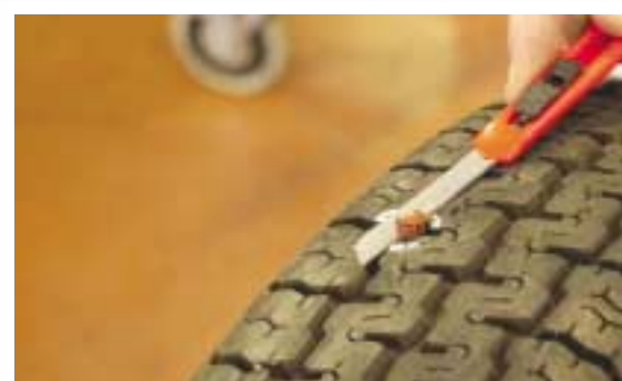
9 Cortar el material de reparación sobrante.
