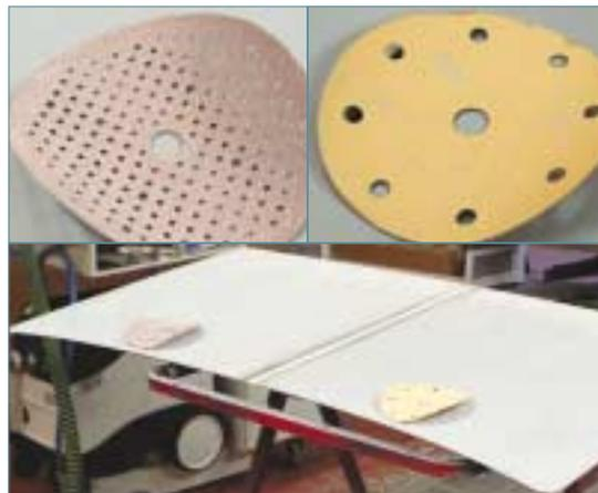
En Centro Zaragoza se han realizado varias pruebas para comprobar su eficacia, entre ellas, el lijado de aparejo de medio capó con dos lijas distintas: lija NORGRIP, P320, y su comparativa en cuanto a embozamiento con una P320 de una gran marca tras cuatro minutos de lijado. El resultado se muestra en la fotografía en la que se aprecia un menor embozamiento en la lija NORTON MULTI-AIR™.
