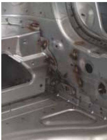
Soldadura CuSi 3 por puntos de tapón
