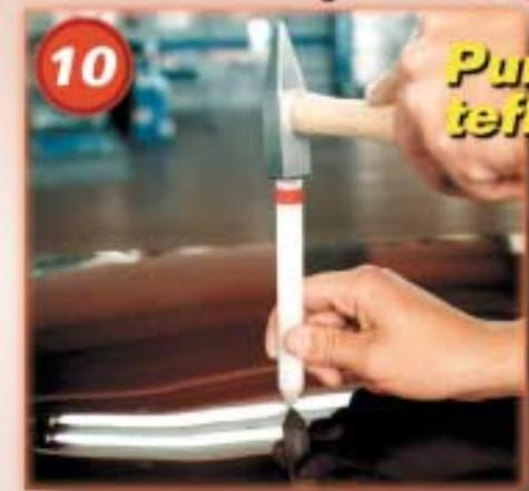
Para daños de protuberancia o para volver a provocar el daño si hemos presionado demasiado fuerte y la chapa se ha endurecido.
