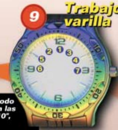
Empujes aplicados según el método del reloj. Primero se presiona en las "12", luego en las "11", "1", "2", "10", "9" y "3".
