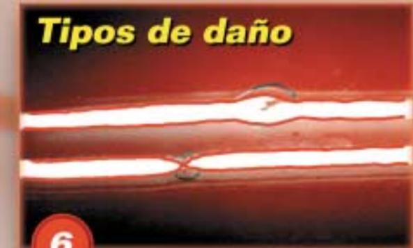
**6** Daño por abolladura (arriba) y protuberancia (abajo)
