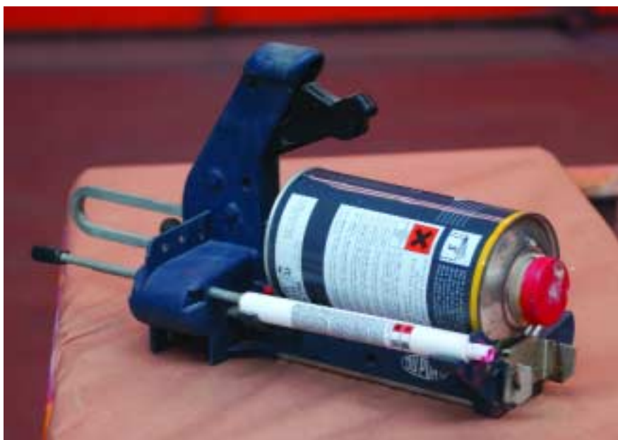
Dosificador para corregir una correcta proporción de masilla y catalizado
