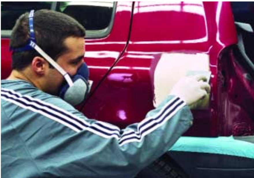
Aplicación de masilla
