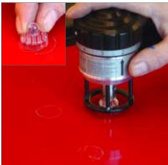
Posteriormente se aplica el adhesivo con la pistola de encolar en el patín, para seguidamente colocarlo en la zona deformada de la pieza. Dependiendo del tamaño del daño se utilizará un patín u otro. Una vez pegado el patín se debe dejar enfriar, para reducir el tiempo de reparación
