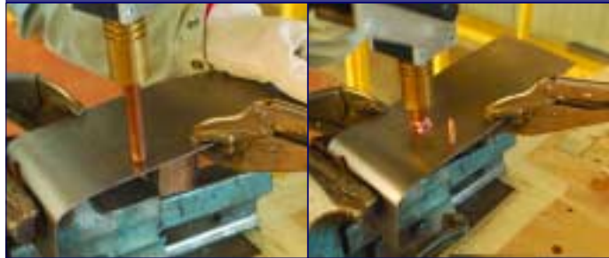
Soldadura por empuje con un electrodo
