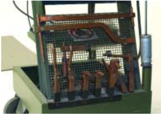
Electrodos para acceder a distintas zonas a soldar
