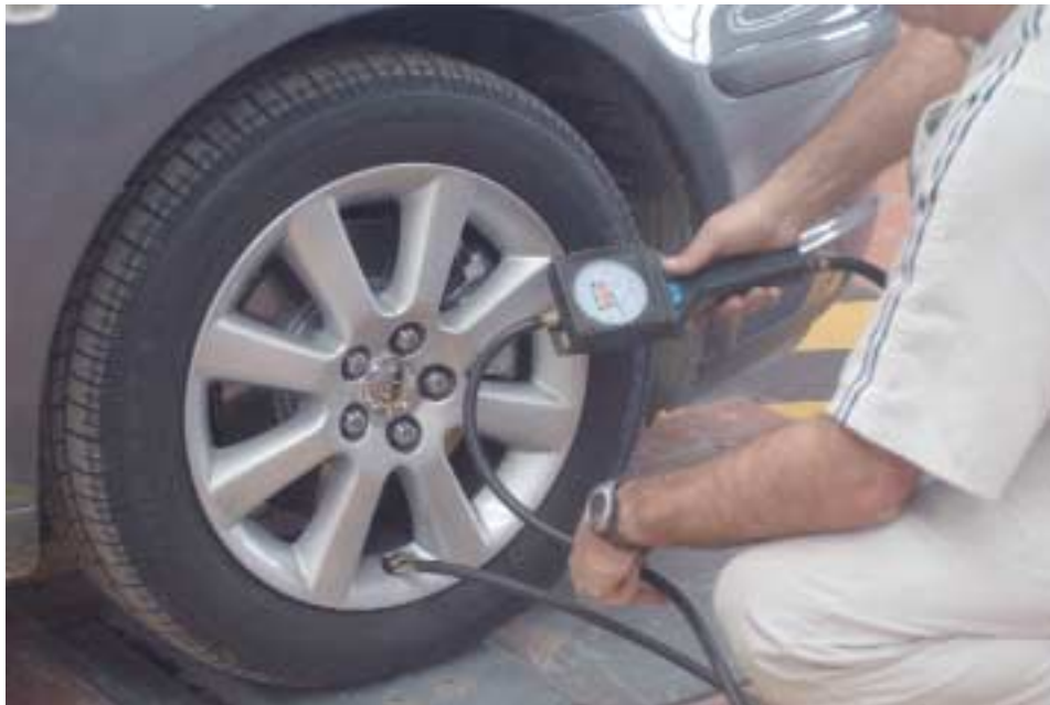
Comprobación de la correcta presión de inflado de los neumáticos.
