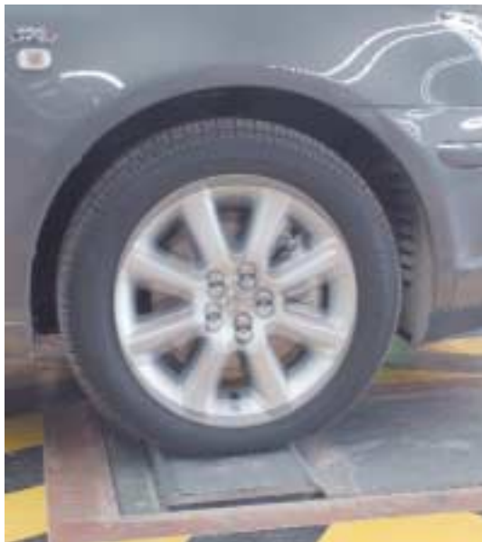
Equipo de placas oscilantes para la comprobación de la suspensión.
