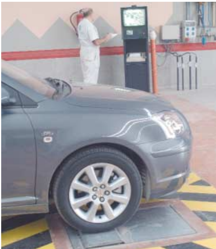
Comprobación de resultados en la diagnosis de la suspensión.
