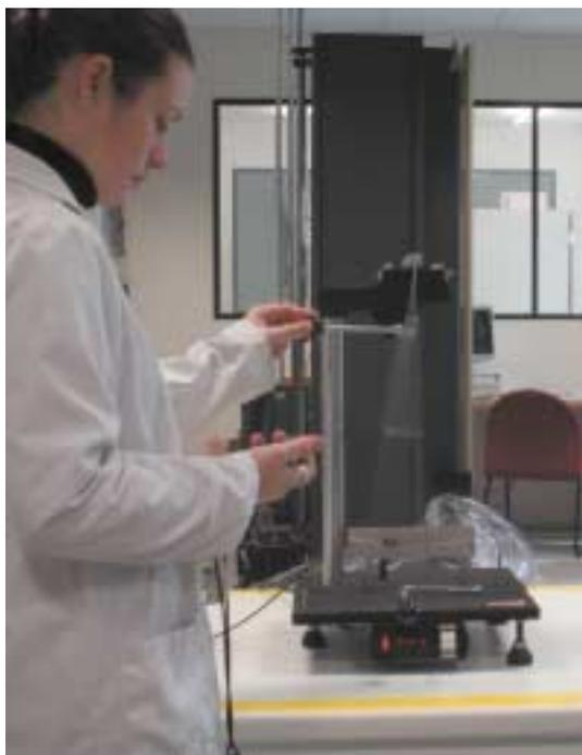
Realización del ensayo de dureza con el péndulo Persoz
