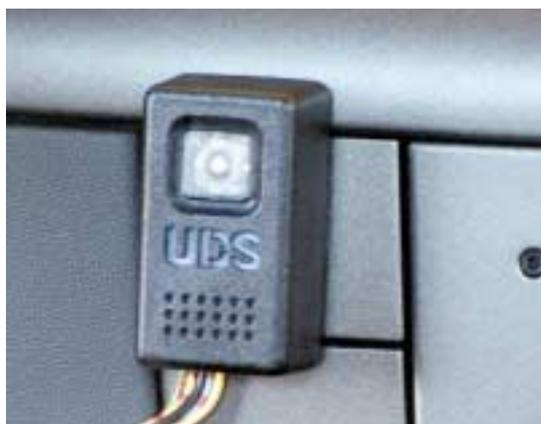
UDS es un dispositivo instalado en el vehículo que registra datos del accidente.
