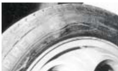
"Hernia" o abultamiento por rotura de lonas interiores del flanco, debida al golpe contra un bordillo
