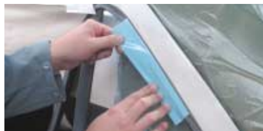
Enmascarado de las molduras de lunas con cinta especial
