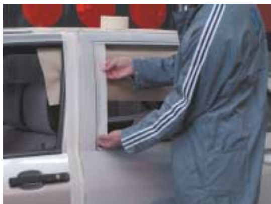
El perfilado de las zonas a pintar es la fase más comprometida del enmascarado
