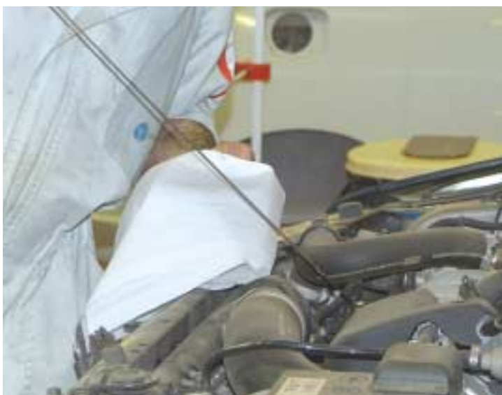
EL CONTROL DEL NIVEL DEL ACEITE DEL MOTOR DEBE REALIZARSE DE FORMA PERIÓDICA PARA EVITAR POSIBLES AVERIAS POR FALTA DE LUBRICACIÓN
