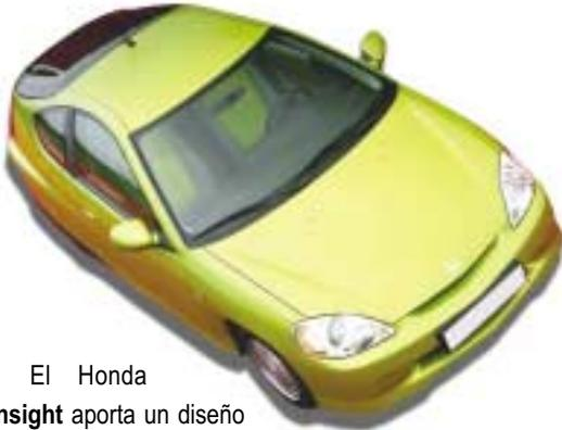
El Honda **Insight** aporta un diseño deportivo en carrocería de dos puertas, e incorpora un motor térmico de tres cilindros de 1.000 cc de cilindrada y 68 CV de potencia, junto a un motor eléctrico de asistencia de 8 CV.
