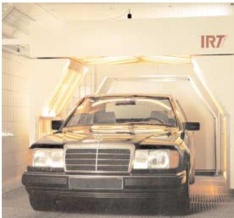
Los equipos de secado por infrarrojos pueden ser muy variados en cuanto a su tamaño, desde pequeños equipos manuales, hasta instalaciones en cabina de pintura (arcos o túneles de secado o paneles laterales), pasando por instalaciones móviles empleadas en la zona de preparación. Éstos tienen su mayor campo de aplicación en el secado de pinturas de fondo (masillas y aparejos), dejando la cabina-horno exclusivamente para el pintado y secado de las pinturas de acabado.
