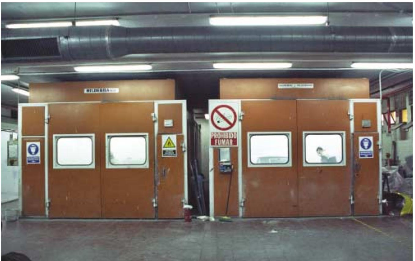
Una cabina de pintura es un recinto cerrado en el que se introduce el vehículo o pieza a pintar, y por el que circula aire desde el techo de la cabina hacia el suelo de la misma. Esta circulación forzada de aire, vertical y hacia abajo, es la encargada de arrastrar los restos de pulverización aerográfica.
