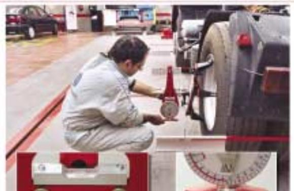
**4** Nivelado del eje del adaptador sobre la horizontal
