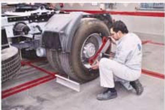
**3** Instalación del adaptador de llanta.
