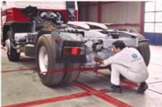
**1** Colocación de reglas autocentrantes. Trasladamos el eje de simetría del bastidor a un lateral.
