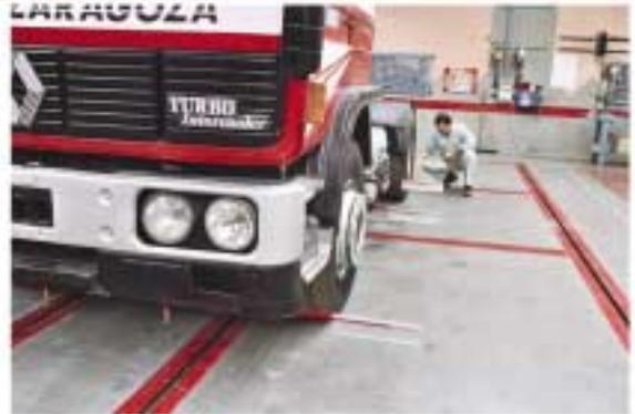
**2** Las reglas no deben situarse en zonas de cambio de sección del bastidor.
