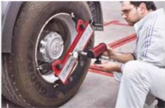
**5** Fijar el proyector laser en el eje del adaptador.
