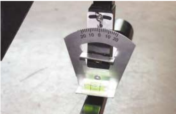
CALIBRE CAMBER, PARA COMPROBAR LA CAÍDA ENTRE LA RUEDA DELANTERA Y LA TRASERA.
