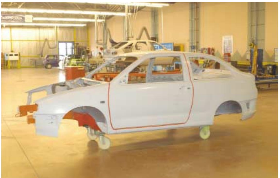
El **atornillado** se utiliza para aquellas piezas a las que no se les exige un comportamiento estructural importante o que se desmontan y montan con relativa frecuencia, este es el caso de las aletas delanteras, los paragolpes, el frente interno, etc.
