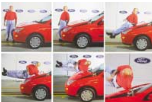
ENSAYO DE ATROPELLO CON DISEÑO ESPECIAL DEL CAPÓ PARA REDUCIR DAÑOS
