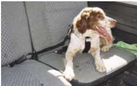
ARNÉS QUE SUJETA AL ANIMAL, MEDIANTE UNA CORREA INSERTADA EN LA HEBILLA DEL CINTURÓN
