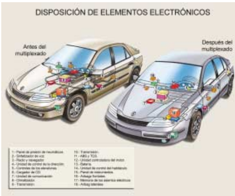
COMPARATIVA DE LA DISPOSICIÓN DE ELEMENTOS ELECTRONICOS, ANTES Y DESPUÉS DEL MULTIPLEXADO EN EL RENAULT LAGUNA
