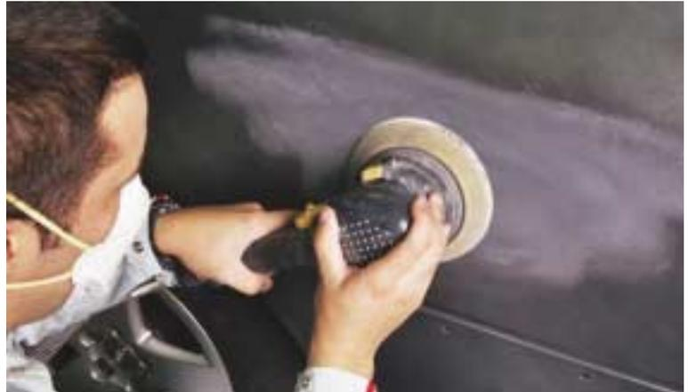
Las lijadoras orbitales o excéntricas, tienen la zapata de forma rectangular y el movimiento que se le transmite es la descripción de una órbita en torno a un eje fijo. Estas lijadoras tienen una gran superficie de lijado y son ideales para el lijado de superficies grandes y planas, además cuando no trabaja en plano da problemas de vibraciones. Sus aplicaciones son: lijado de masillas y cualquier lijado en áreas planas.
