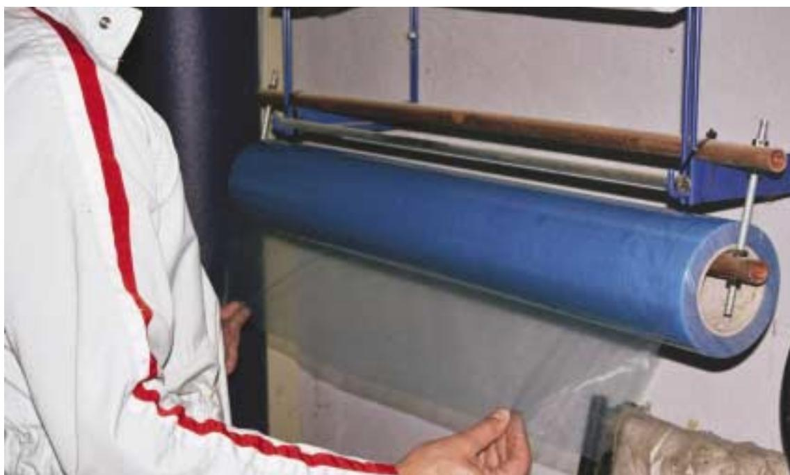
**S**mashwrap es una lámina de protección autoadhesiva que sirve principalmente para impermeabilizar el interior del habitáculo, así como para cubrir la cara interna de las puertas.
