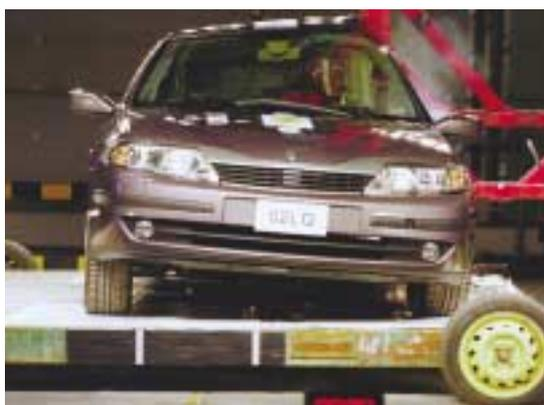
El impacto lateral intenta reproducir la situación en la que un vehículo colisiona contra el lateral de otro, y por ello la prueba se realiza con el vehículo estacionario contra el que impacta una barrera móvil de 950 Kg de masa a una velocidad de 50 Km/h.
