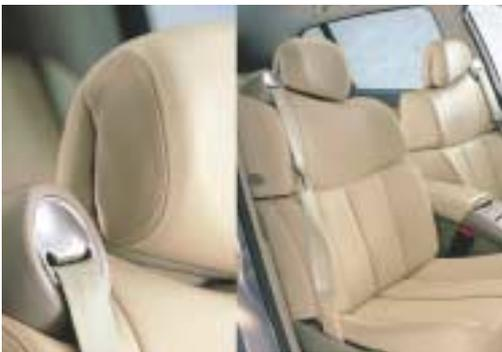
Los cinturones de seguridad de las plazas delanteras van integrados en los propios asientos consiguiendo un mejor ajuste y aumentando, por tanto, la protección y el confort. De serie, el Vel Satis lleva incorporados, además de los airbag frontales autoadaptativos, airbag laterales en las plazas delanteras y dos airbag de cortina para las plazas delanteras y traseras.
